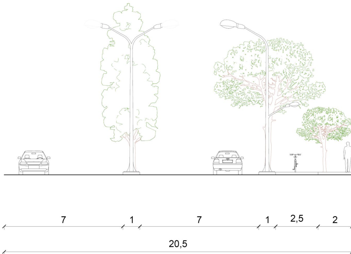
Figura 1 – strada urbana a due corsie per senso di marcia, pista ciclabile e pedonale su un lato
