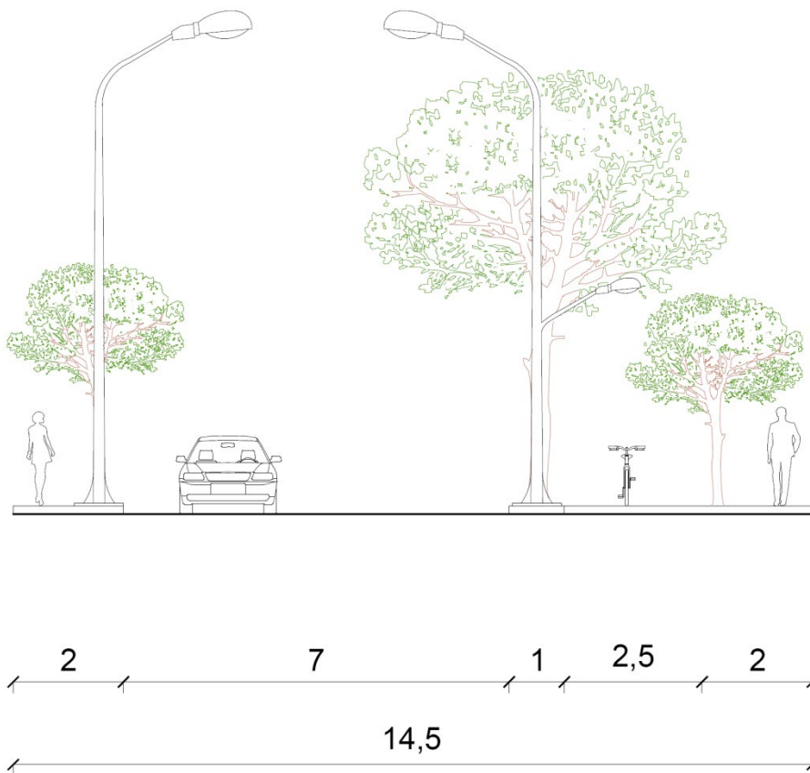
Figura 5 - strada urbana a due corsie, pista ciclabile, un pedonale per lato
