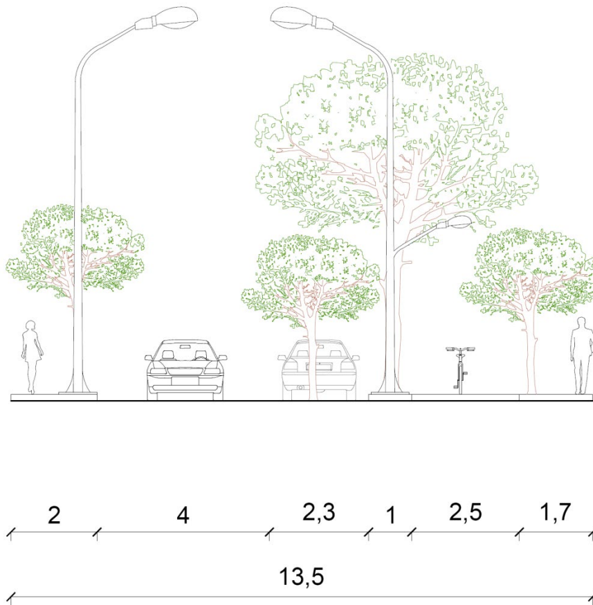
Figura 6 - strada urbana ad una corsia, parcheggio longitudinale, pista ciclabile, un pedonale per lato
